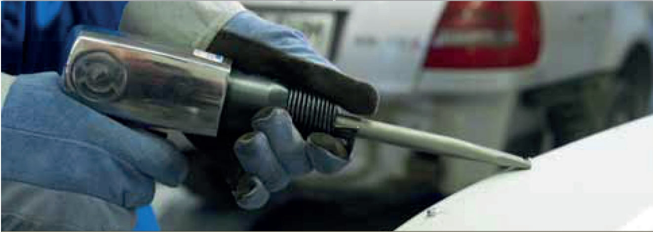
ดอกสกัดลม ปากแบน (Flat Chisel) 1514A1
